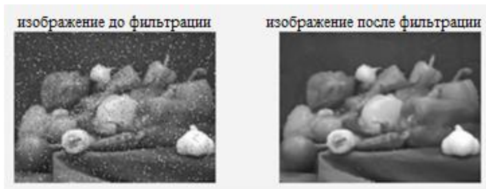
Рис. 5. Исходное изображение с шумом соли и перца и обработанное изображение с использованием метода усредненной фильтрации
