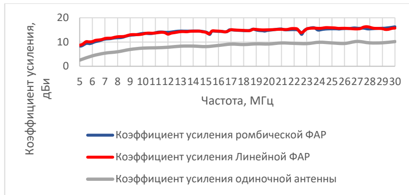
Рис. 5 Графики зависимости КУ от частоты для одиночного излучателя, линейной и ромбической ФАР
