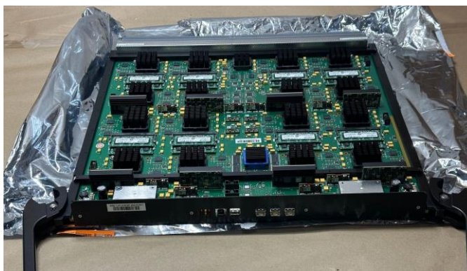
Рис. 2. Одна из плат для Veloce 2 Quattro Emulator (изображение взято с сайта https://www.ebay.com.my/itm/364053410653 )
